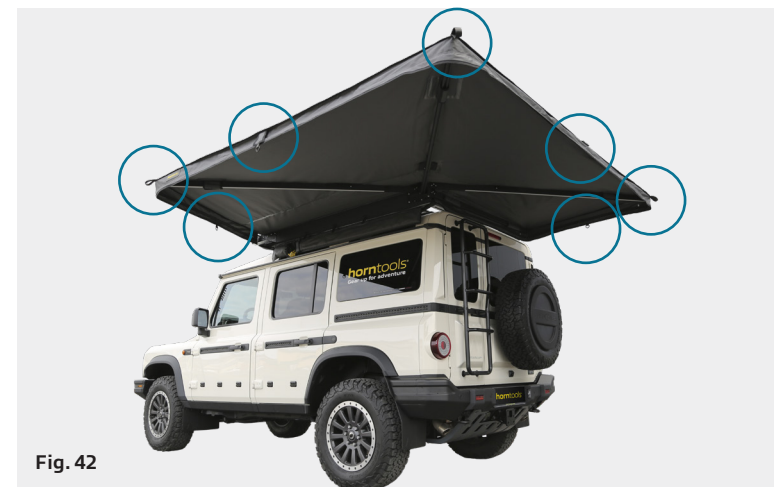
Positions des boucles textiles et des anneaux en D
