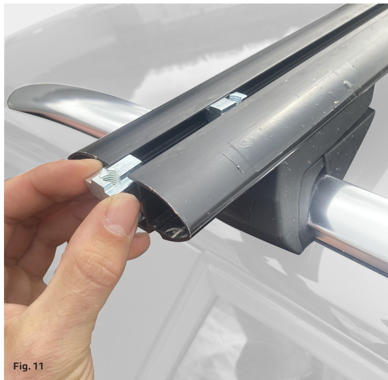
Mise en place des écrous coulissants
