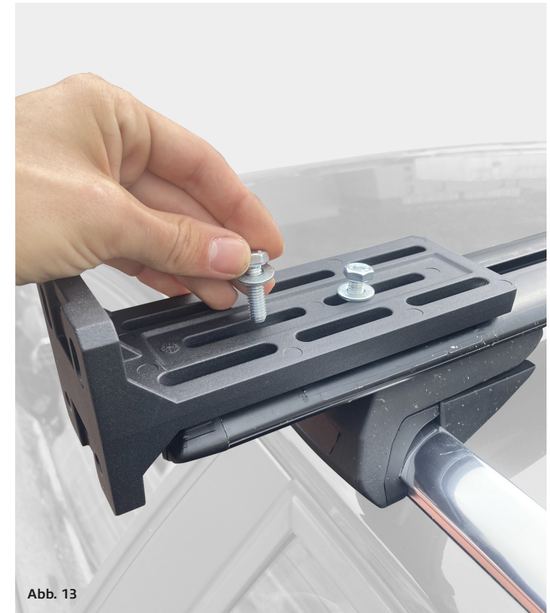
Platzierung der Universalhalterung auf Querträger
