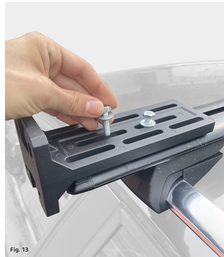
Colocación del soporte universal en el travesaño
