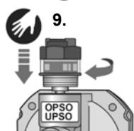
**BEMÆRK** OPSO / UPSO: Hvis der er installeret meget lange rørledninger ved produktets udløb, kan det være nødvendigt at trække spindlen **B** med oplåsningsanordning **C** ud og holde den i flere sekunder, indtil trykudligning er opnået.
