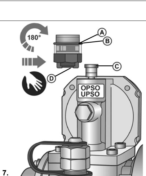
7. Повернуть защитный колпачок **(A)** / **(B)**. Наденьте деблокирующее устройство **(D)** на шпиндель **(C)**.
