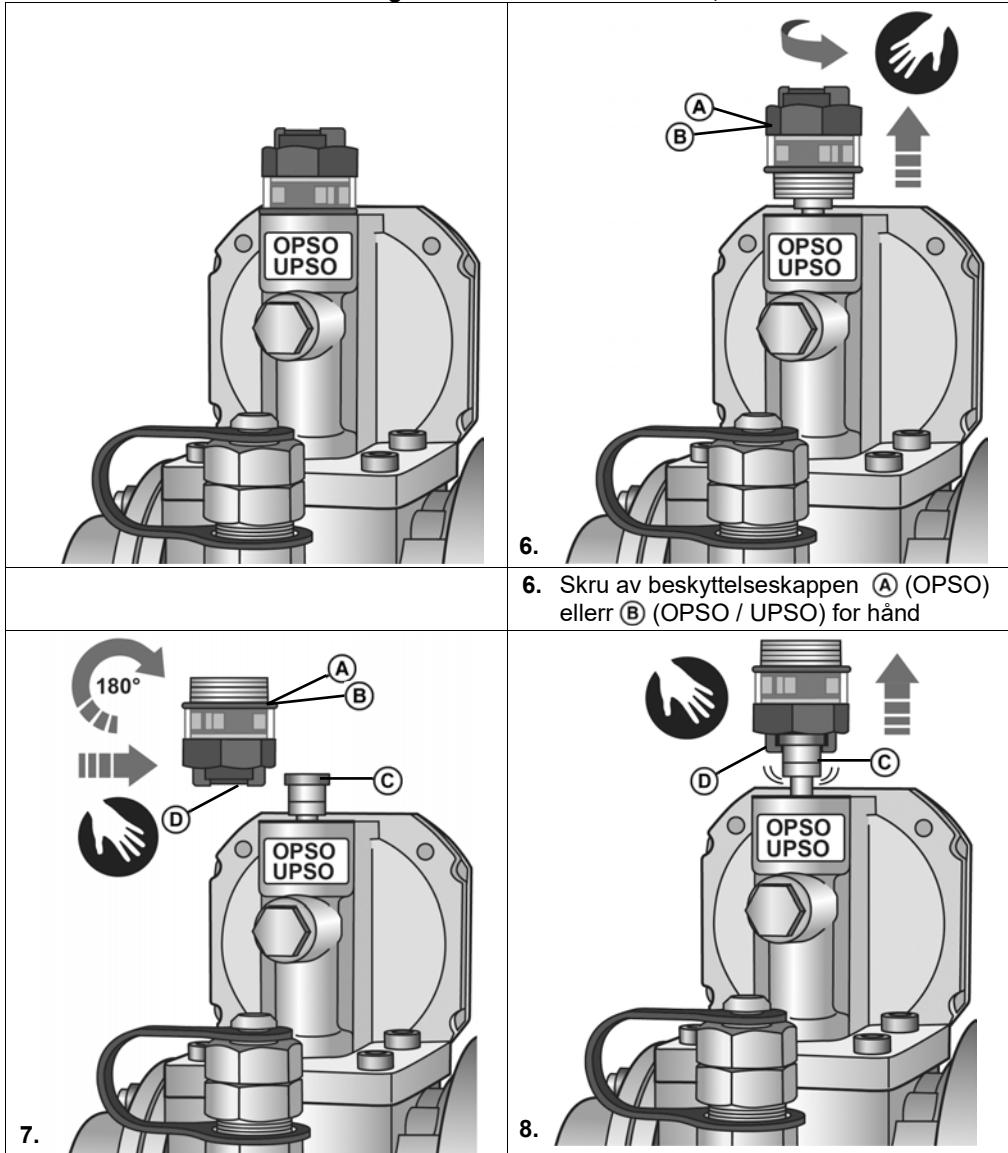
7. Snu beskyttelseskappen Ⓐ / Ⓑ, skyv åpnearrøringen Ⓓ på spindelen Ⓒ.
