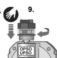
**УВЕДОМЛЕНИЕ OPSO / UPSO:** Если на выходе изделия смонтирован очень длинный трубопровод, то возможно, потребуется извлечь и удерживать шпиндель **B** с помощью устройства разблокировки **C** в течение нескольких секунд до тех пор, пока не произойдет выравнивание давления.
