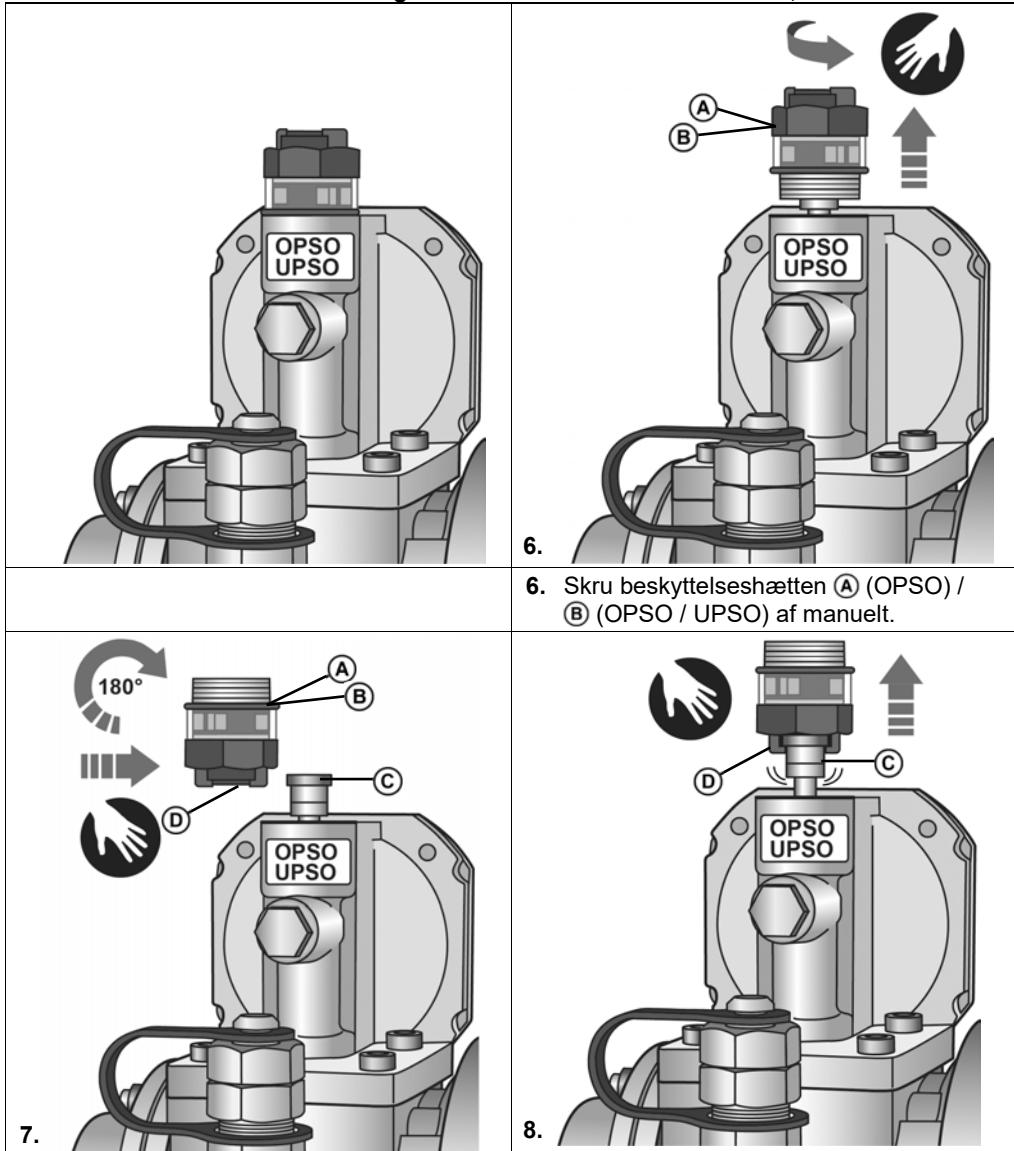
7. Vend beskyttelseshætten **(A) / (B)** om, skub åbningsanordningen **(D)** på spindlen **(C)**.
