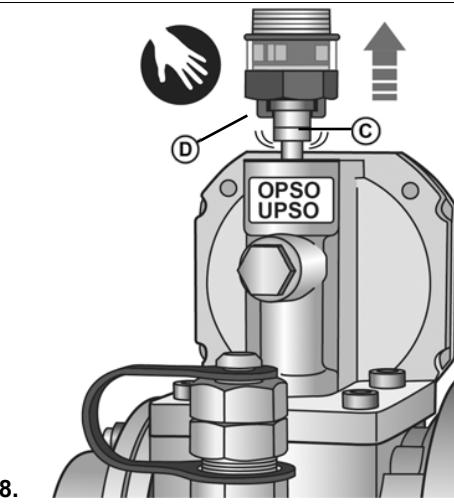
7. Apgrieziet aizsargkapi (A) / (B). Uzvelciet atbloķēšanas (D) ierīci uz vārpstas (C).
