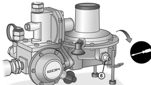
В рамках проверки давления и герметичности установки на проверочное присоединение можно присоединить прибор для проверки герметичности. После использования, присоединение плотно закрыть и заново проверить на герметичность см. «ПРОВЕРКА ГЕРМЕТИЧНОСТИ!»
