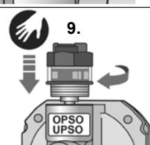
**UPOZORNĚNÍ | OPSO / UPSO:** Pokud jsou na výstupu výrobku namontována velice dlouhá potrubí, je za určitých okolností nutné vytáhnout vřeteno **B** pomocí zařízení pro odblokování potrubí **C** a přidržet několik sekund, dokud nedojde k vyrovnání tlaku.
