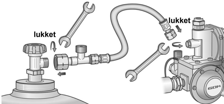
3. Skru først nødforsyningsarmaturet på nødforsyningstilslutningen, og forbind det derefter med gasflasken (SW 30).
