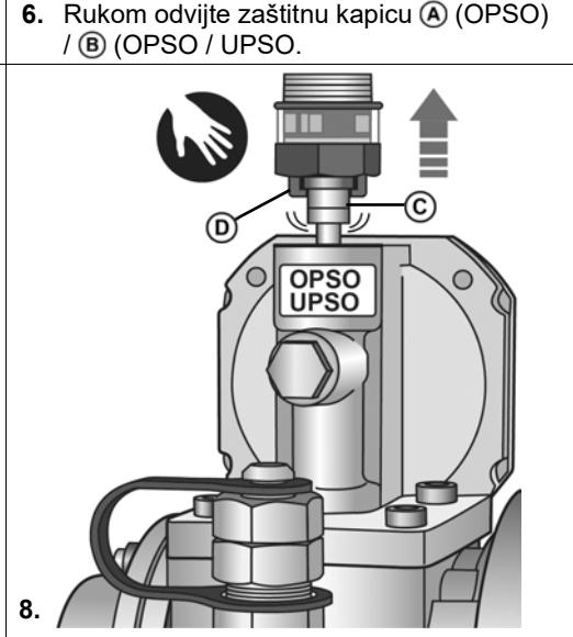
7. Okrenite zaštitnu kapicu (A) / (B). Gurnite mehanizam za deblokadu (D) na vreteno (C).
