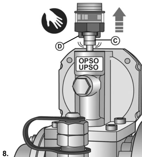
7. Schutzkappe **A** / **B** umdrehen. Entriegelungsvorrichtung **D** auf Spindel **C** schieben.
