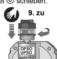
**HINWEIS** OPSO / UPSO: Wenn am Ausgang des Produktes sehr lange Rohrleitungen montiert sind, ist es unter Umständen nötig, die Spindel C mit Entriegelungsvorrichtung D herauszuziehen und mehrere Sekunden zu halten, bis sich ein Druckausgleich einstellt.
