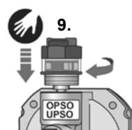
**MERK** **OPSO / UPSO:** Hvis det er montert svært lange rørledninger på produktutgangen, kan det bli nødvendig å trekke ut spindelen **B** med opplåsingssanordningen **C** og holde den flere sekunder til det oppstår en trykkutjevning.
