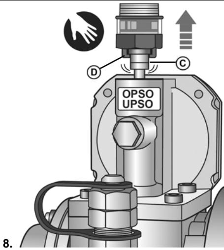
7. Retourner le capuchon protecteur **A** / **B**. Pousser le dispositif de déverrouillage **D** sur levérin **C**.
