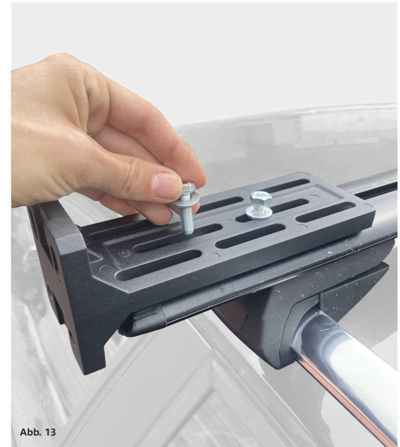
Platzierung der Universalhalterung auf Querträger
