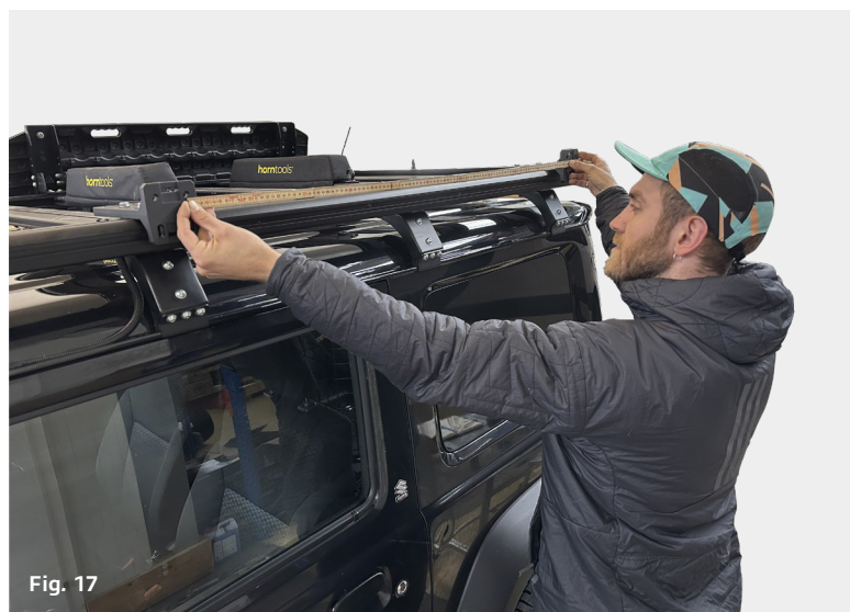
Distance entre les trous de fixation
