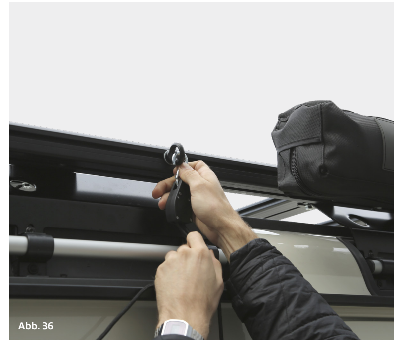
Markisenspanner in Ringschraube
