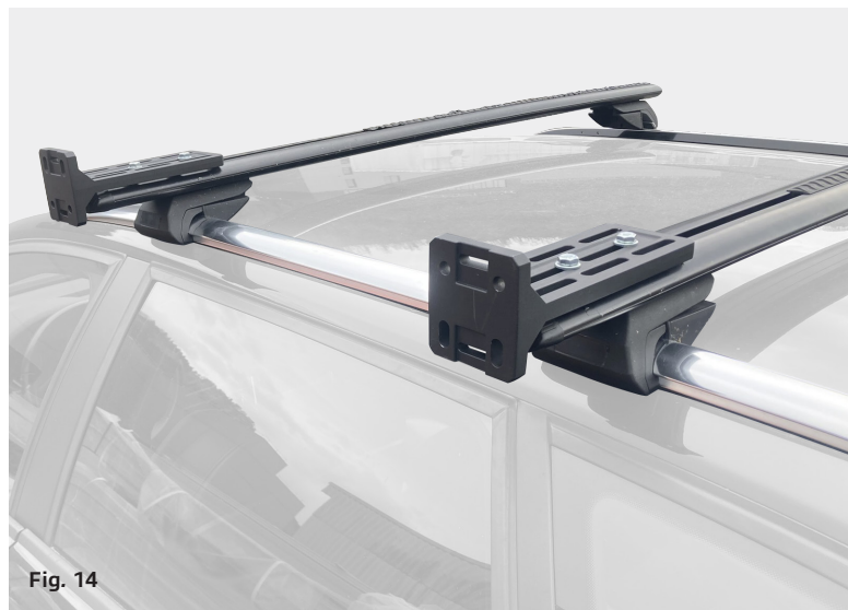
Soportes universales instalados
