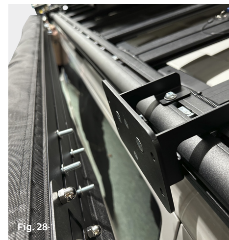
Montaje del toldo en el soporte del toldo
