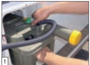
Voor het uittrekken van de bak moet de slang uit de grote slangaansluiting naar voor worden getrokken.
