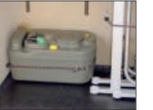
Se per la sostituzione si dovesse utilizzare una seconda cassetta, allora è possibile portare con sè la cassetta piena per più giorni nello spazio di ritegno del bagagliaio tenendola ben chiusa. (In una cassetta piena non vi è più alcuna formazione di gas.)
