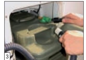
Cassette einschieben, Verschluss (schwarz) nach vorne abziehen, und Absaugschlauch auf Schlauchanschluss (grün) aufstecken.
