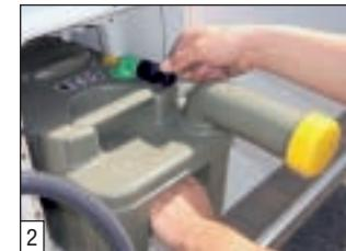
Zet het zwarte afsluitdop op de slangaansluiting (groen). Trek de bak eruit en leeg deze op een gepaste plaats.
