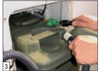
Insérez la cassette, tirez le bouchon (noir) vers l'avant et mettez le tuyau d'aspiration sur le raccord de tuyau (vert).
