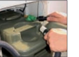
Inserire la cassetta, staccare il coperchio (nero) tirandolo in avanti e inserire il tubo di aspirazione nell'attacco (verde) del tubo flessibile.
