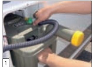
Afin de retirer la cassette, tirez le tuyau du raccord de tuyau (vert) vers l'avant.
