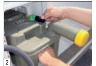
Schwarzer Verschluss auf Schlauchanschluss (grün) aufstecken. Cassette herausziehen und an entsprechender Stelle entsorgen.
