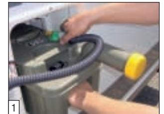
Vor dem Herausziehen der Cassette muss der Schlauch vom grünen Schlauchanschluss nach vorne abgezogen werden.
