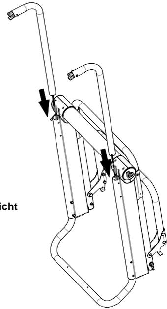
**3. fix upper tube / fixez tube supérieur / fixeer bovenste buis / Oberes Rohr befestigen**
