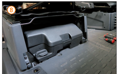
Werkzeugbox entfernen, dazu Verriegelung lösen.
