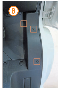
Verkleidung Kabelkanal auf der Beifahrerseite entfernen, dazu drei lange Kreuzschlitzschrauben entfernen. Ggf. weitere modellspezifische Verkleidungen entfernen.
