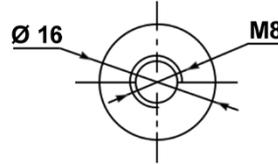
Anschluss: M8 Schraube oder M8 Poladapter
