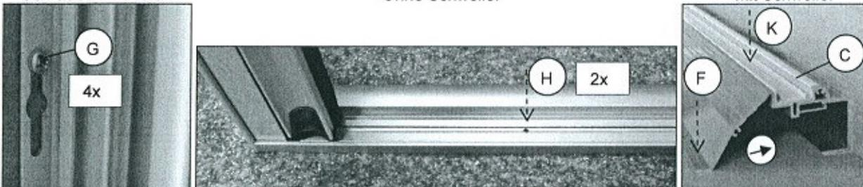
Der letzte Schritt ist das Befestigen der Unterschiene mit 2 Schrauben H.
