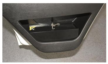
Nachdem der Kleber ausgehärtet ist, kann der Safe auf der eingeklebten Montageplatte mit den mitgelieferten Schrauben befestigt werden.
