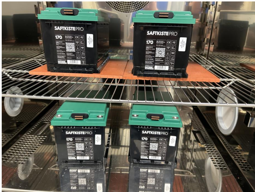
Bild 8: Lithium-Ionen-Batterie Typ Saftkiste PRO170 in der Klimakammer
