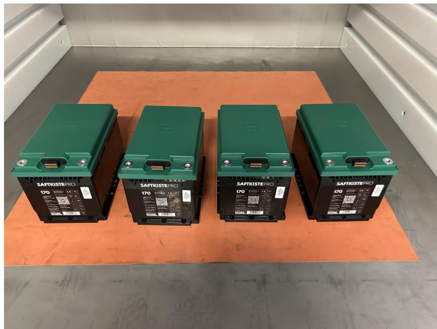
Bild 5: Lithium-Ionen-Batterie Typ Saftkiste PRO170 in der Vakuumkammer
